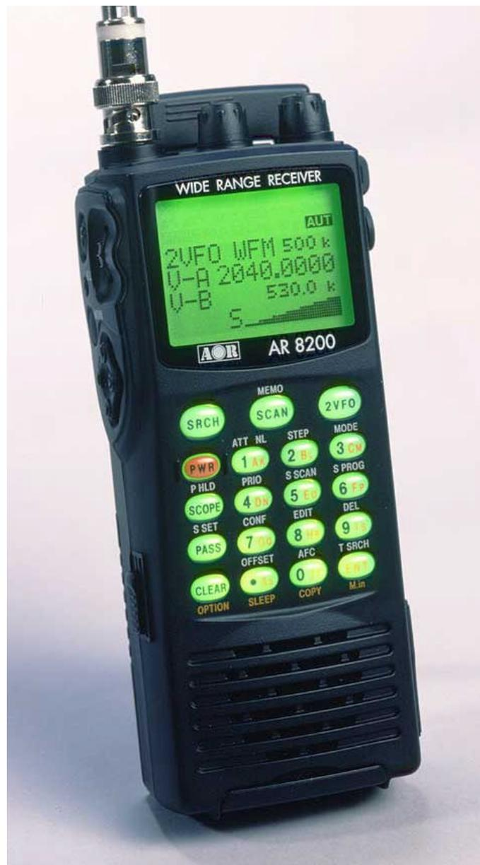
Der AOR AR8200-Serie 2 ist ein Modell der absoluten Top-Klasse. Sein " Herzstück " ist der neue Temperatur stabilisierte Quarz-Oszillator, der für größte Frequenzstabilität sorgt. Ein Feature welches eigentlich bisher nur bei sehr teuren Empfängern zu finden war. Das neu entwickelte beleuchtbare Eingabefeld sorgt ebenso wie die (serienmäßig) mitgelieferten 1100 mAh NiCd Akkus für großen Bedienungskomfort.
